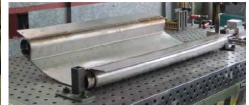
Figure 186 : Echangeur installé dans un ovoïde existant (Rabtherm), échangeur pour collecteur existant (Uhrig) Source : Lyonnaise des Eaux
