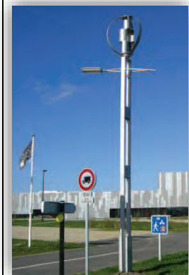
Éolienne mixte Darrieus / Savonius pour l'alimentation autonome d'un lampadaire – Commune de Bouvron
