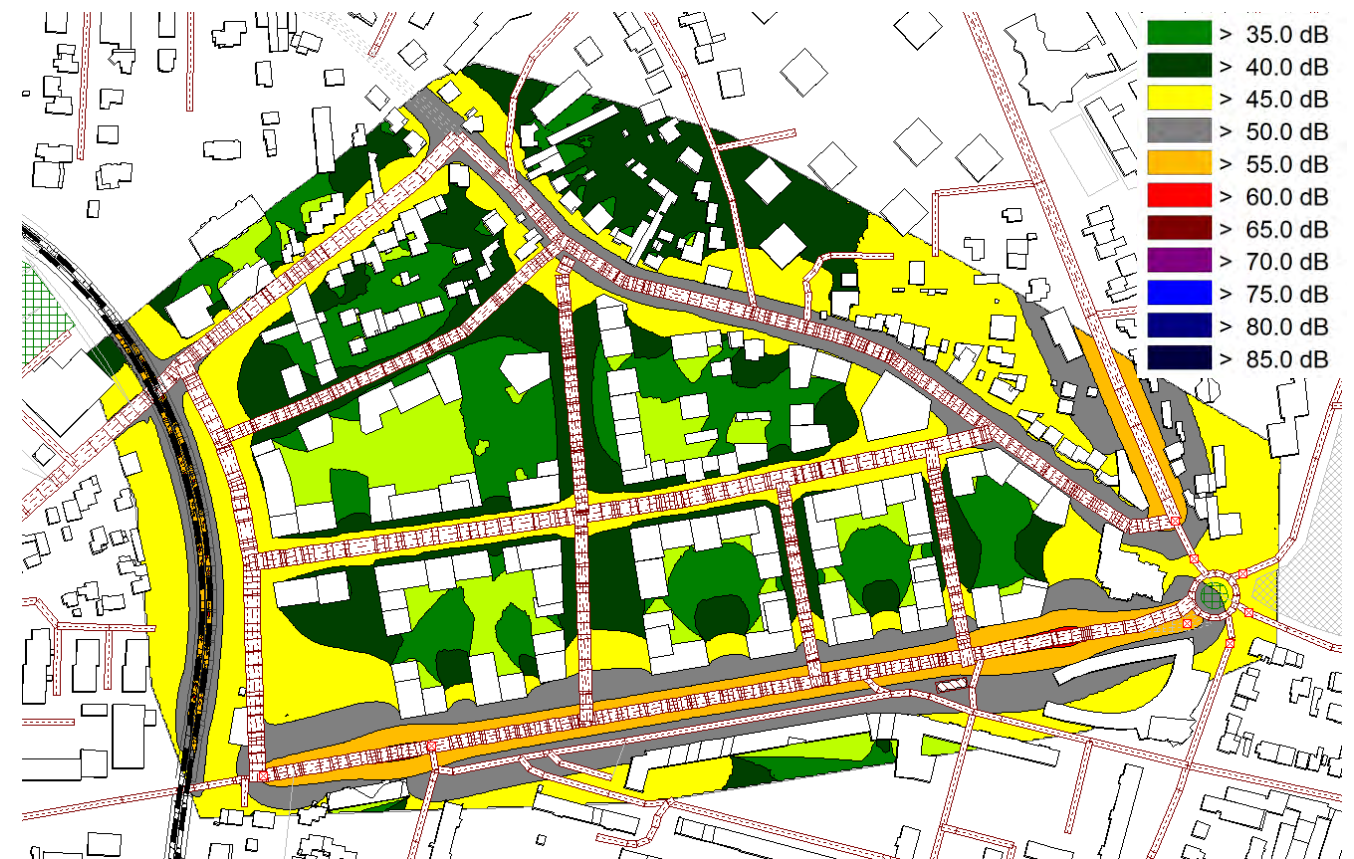
Figure 257 : Niveaux de bruit à l'état projet à 4 m du sol en période nocturne (22h-6h)
