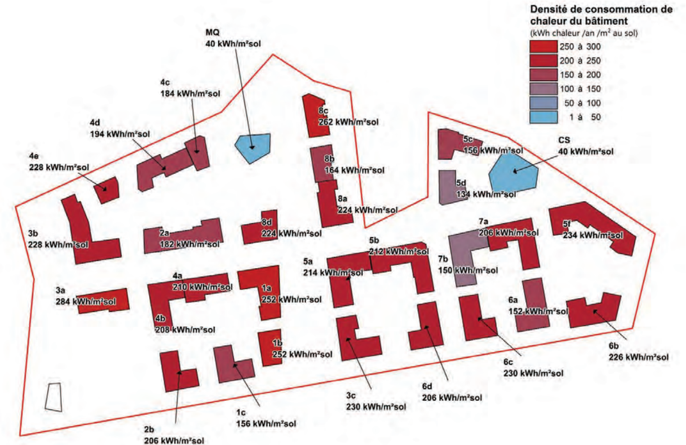
Figure 5 : Densité de consommation d'énergie finale pour le chauffage et l'eau chaude sanitaire des bâtiments
